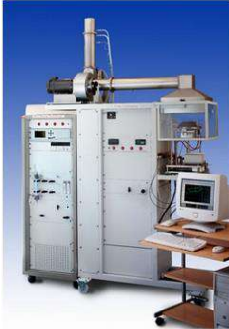
Figura 1. Cono calorimetro FTT (Rif. 2-e) utilizzato per le prove sperimentali.
