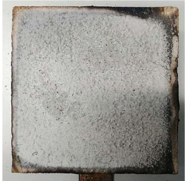
Campione dopo il test di non combustibilità
