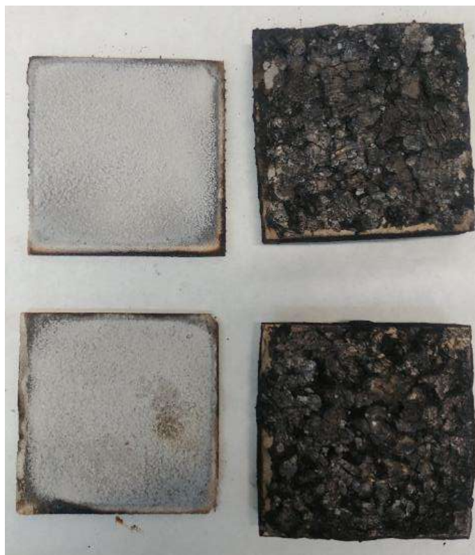
Figura 4. Distacco del rivestimento dal substrato dopo il test di non combustibilità.
